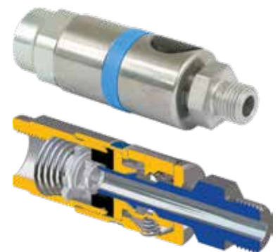
Doorsnede van Stäubli RCS, de lange geleiding is goed zichtbaar
